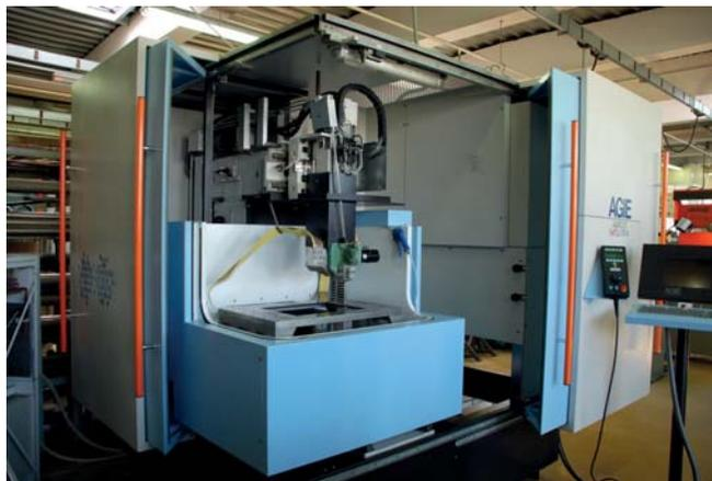
Machine Electron-Erosion à fil (\*)
